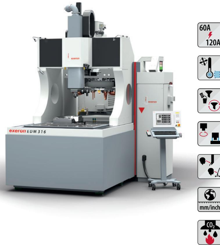
**e** Höchste Stabilität durch FEM-optimierten, ungeteilten Maschinengrundkörper in Hybridbauweise
